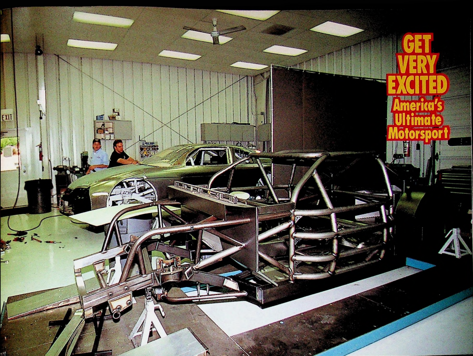
ここからエンジン、サスペンション、ボディなどの各パーツを取りつけ完成させるのに約2週間。シボレー、フォード、ポンティアックとあるが、フレームの構造はどこもほぼ同じだ。
